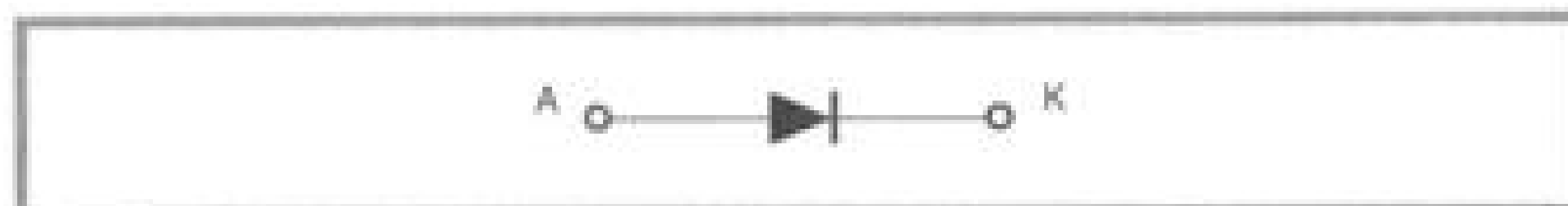
Figure 1.11 – Distinction entre anode et cathode sur le symbole d'une diode.
